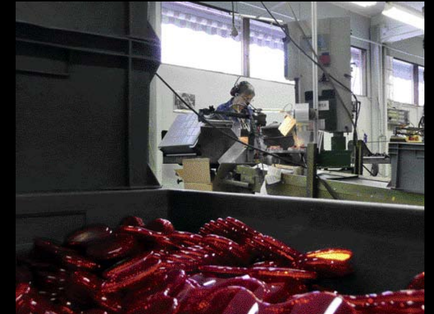
Hochfrequenz-Verschweißung der Reflektoren ist hier Standard.
