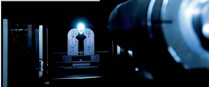
Im „Light Laboratory“ prüft Herrmans die Luxstärke der Beleuchtungsprodukte.
